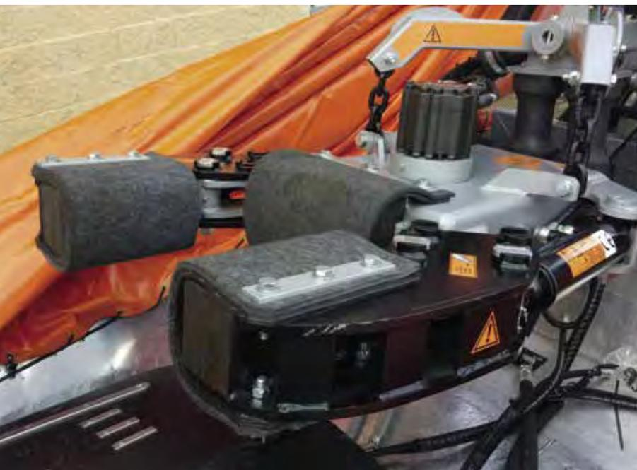
A scelta, possiamo montare i bracci specifici per albero giovane, che permetterà di eseguire le vibrazioni senza provocare nessun danno all'albero, ai tronchi che oscillano tra gli 8 e i 30 cm. La vibrazione ottenuta e i risultati di caduta saranno eccellenti.
