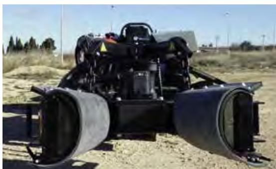
Per l'adeguamento a qualsiasi tipo di diametro del tronco, da 8 a 45 cm, è possibile configurare diverse parti della testa.
